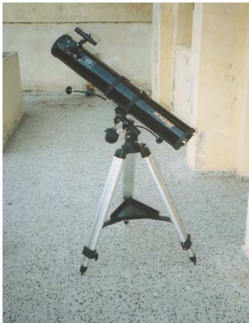
Figura 1. Telescopio reflector Newtoniano Distancia focal 900 mm
