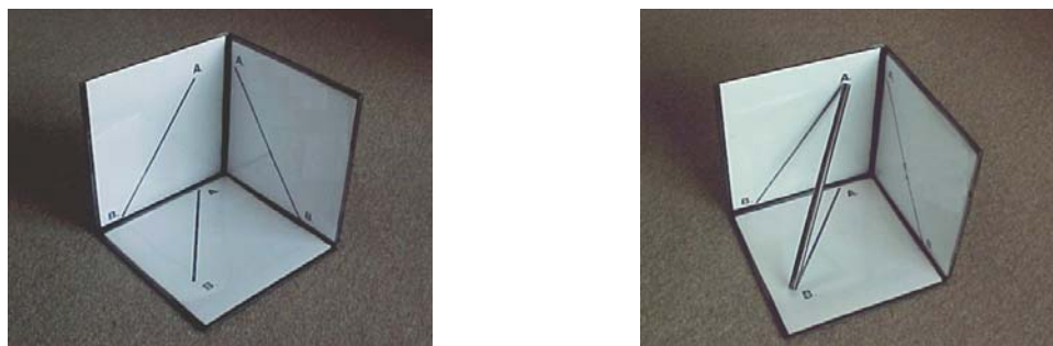
Figura 7 Dispositivo en posición del triedro de proyección con y sin el objeto a proyectar
